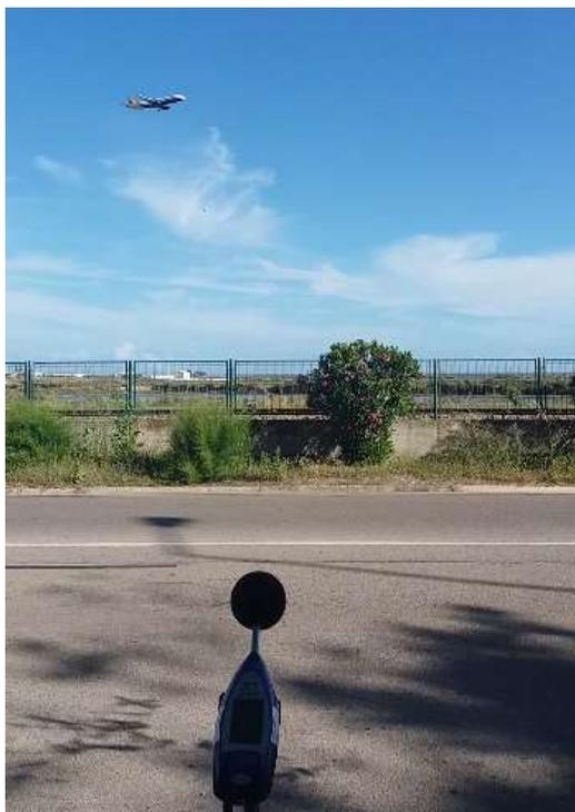
Para as gravações áudio, à passagem das aeronaves e efetuadas em simultâneo com as medições dos níveis sonoros, foi utilizado um *smarthphone*.
